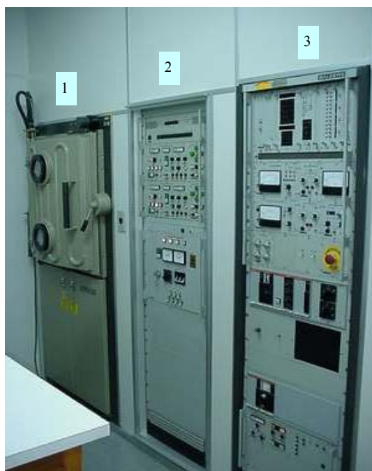
Fig. 5.39 – Vista geral da evaporadora constituída por (1) câmara de vácuo, (2) sistema de controle de potência para o canhão de elétrons e (3) micro-computador e controle de vácuo.
