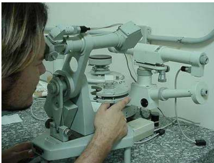
Fig. 5.31 – Goniômetro comparador para a medida de ângulos de prismas.
