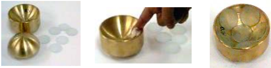
Fig. 5.12 - Esquema de montagem de blocado para lapidação e polimento de uma superfície convexa.
