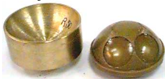
Fig. 5.14 - Bloco pronto para o processo de lapidação.
