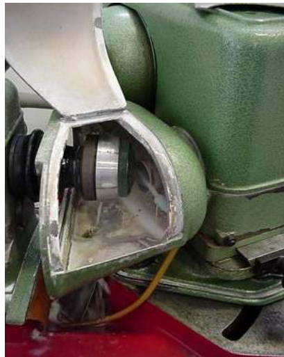
Fig. 5.8 - Geração de uma superfície esférica convexa.
