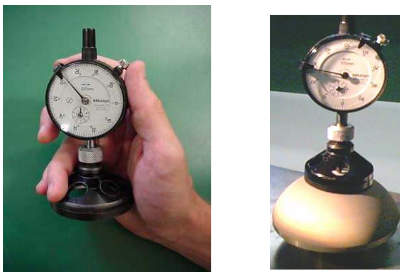
Fig. 5.9 - Esferômetro para controle do raio de curvatura.
