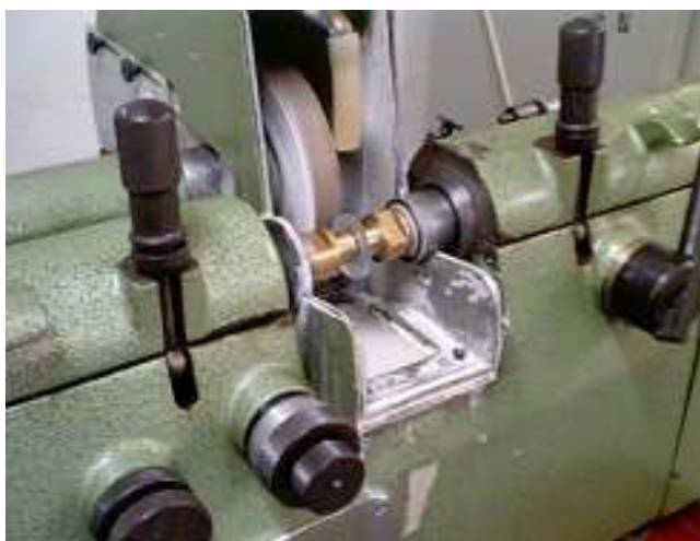
Fig. 5.23 - Máquina usada na centralização de lentes.
