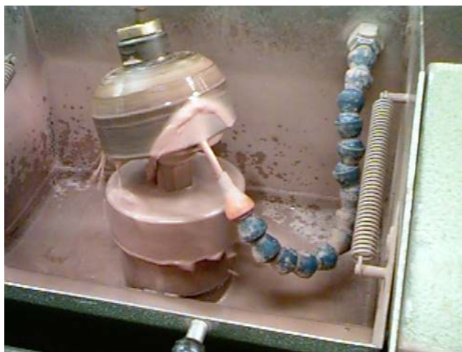
Fig. 5.20 - Máquina utilizada para polimento de lentes.
