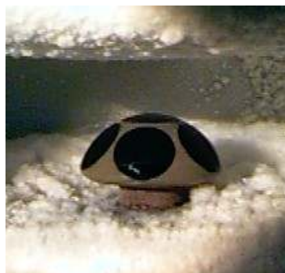
Fig. 22 - Processo para destacamento das lentes por refrigeração do bloco.
