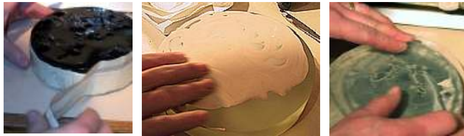
Fig. 5.18 - Remoção da moldura de fita, espalhamento de abrasivo e contato entre o polidor e vidro plano.
