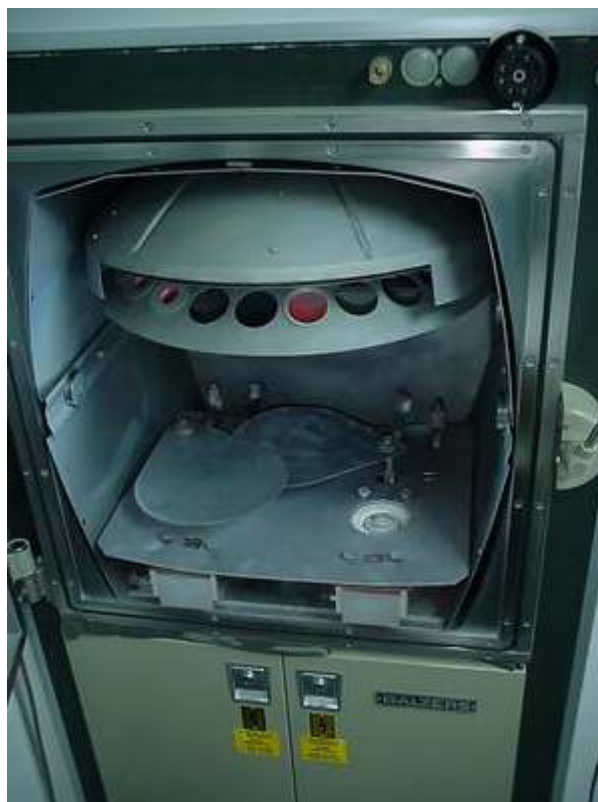
Fig. 5.41 – Interior da evaporadora, com destaque no local onde colocamos os materiais que serão evaporados.
