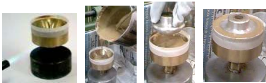
Fig. 5.13 - Seqüência de montagem do blocado.
