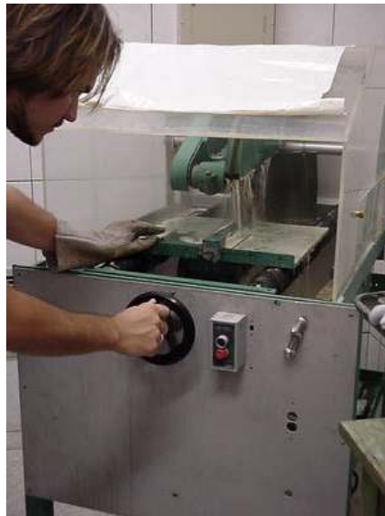
Fig. 5.5 - Serra diamantada circular.
