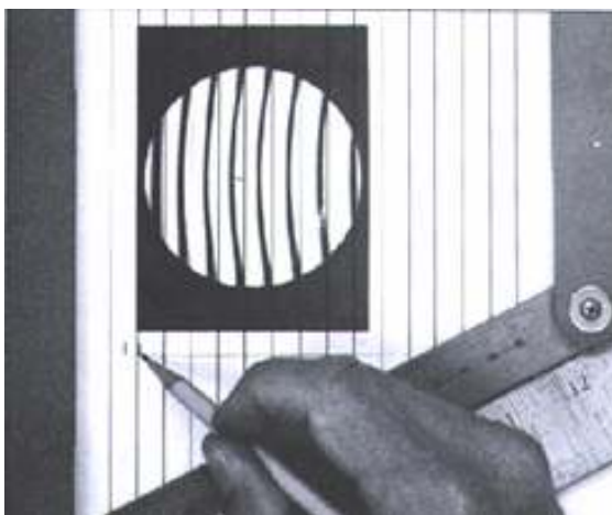
Fig. 5.29 – Medida do máximo desvio de uma franja.
