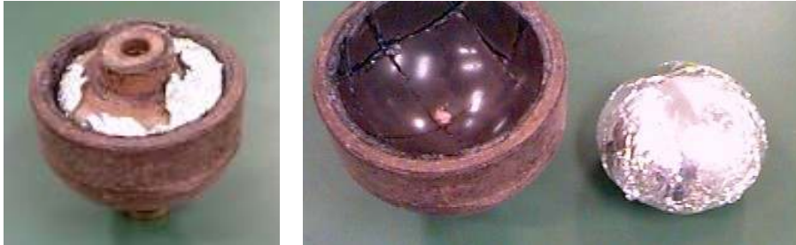
Fig. 5.17 - Montagem de polidor de piche.
